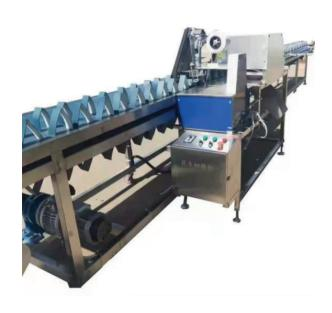
Автоматическая линия для обрезания луковиц обеспечивает на выходе чистые стебли без деформации и презентабельный вид цветов. Линия может работать с тюльпанами различных сортов, а также с цветами иных видов.
